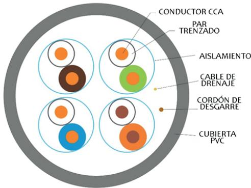
El cable U/FTP (Unshielded Foiled Twisted Pair) /par trenzado sin blindaje) es un tipo especial de cable de alta velocidad (10 Gbps) y muy alta frecuencia (500 Mhz) que cuenta con un blindaje de aluminio en cada par trenzado, protegiéndolos de cualquier señal externa que pueda interrumpir la transmisión de datos, por lo cual hace de este cable el ideal para instalaciones profesionales que requieran alta integridad y velocidad.
